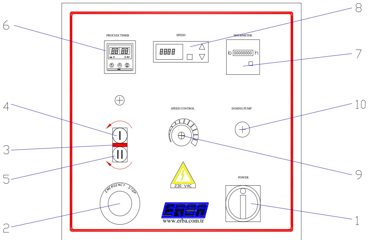
**Тумблер выключателя (1):** “0” обозначает выключение, а “1” - включение. Дверцу панели управления можно открыть только в положении “0”.
